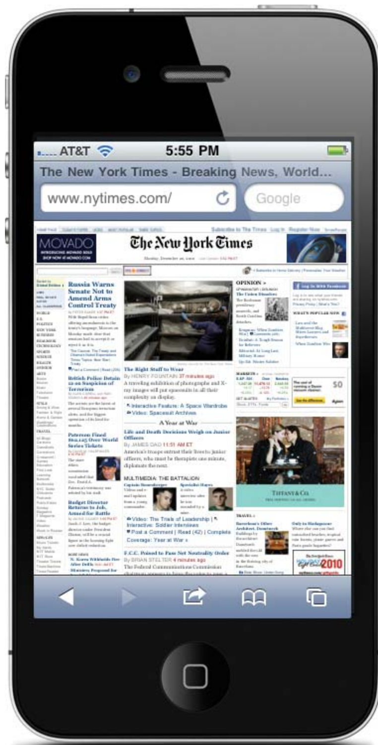
Рис. 4.9. По умолчанию браузер Mobile Safari воспроизводит контент с шириной 980px, даже когда вы держите телефон в горизонтальной плоскости и ширина ограничена 320px
