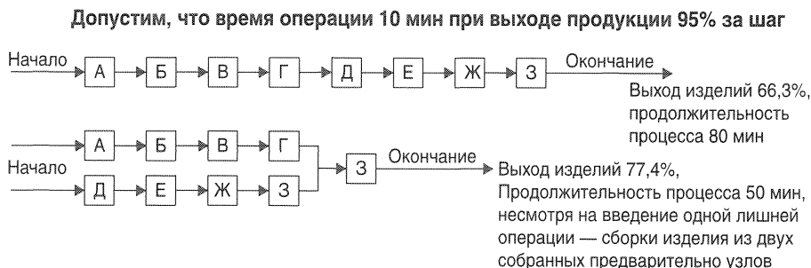
Рис 7.1. Преимущества параллельной сборки (или параллельного химического синтеза)
