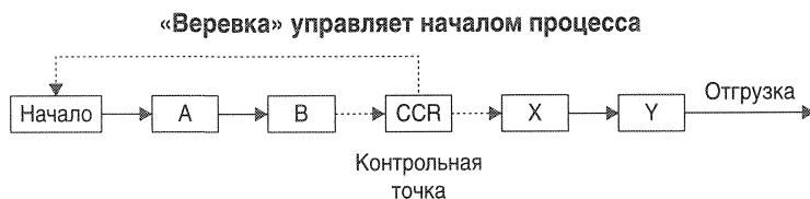
Рис. 7.3. Система «барабан-буфер-веревка» (DBR)
