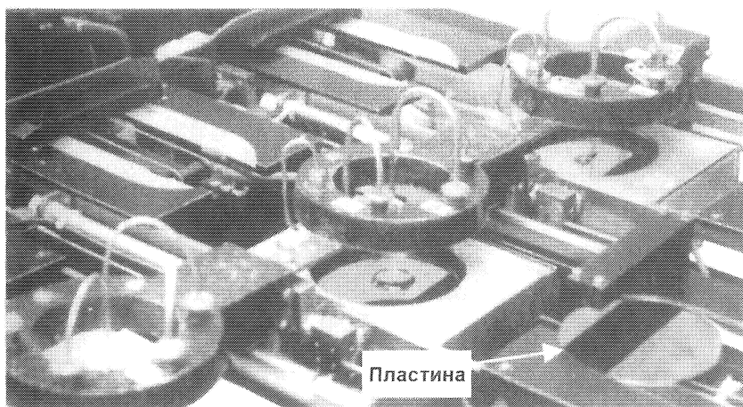
Рис. 6.2. Установка кремниевых пластин для нанесения покрытий методом центрифугирования Источник: Levinson, Leading the Way to Competitive Excellence . Milwaukee: ASQ Quality Press, 1998
