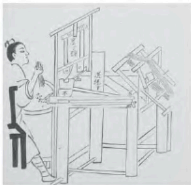
Технология вытягивания шелковой нити-сырца из кокона
