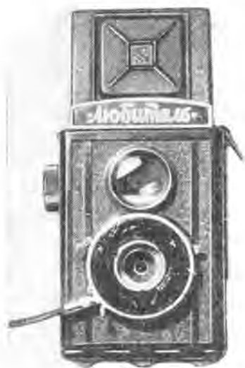
Рис. 1. Фотоаппарат «Любитель». В нижний фотообъектив вставлена пластинка с постоянной диафрагмой
