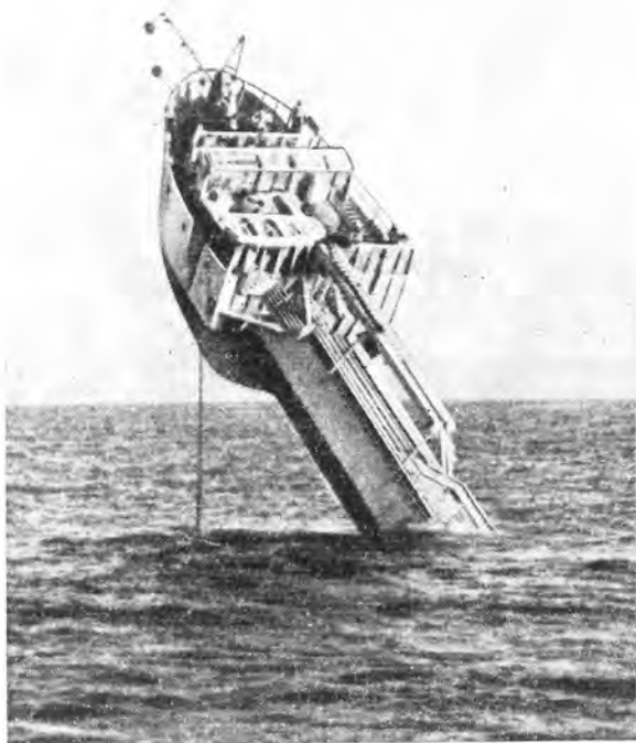
Рис. 2. В трюмы «ФЛИПа» открыт доступ забортной воде — нос погружается, а корма вздымается все выше
