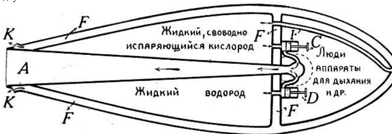
**Схематический набросок проекта межпланетного дирижабля Циолковского (в разрезе).**
