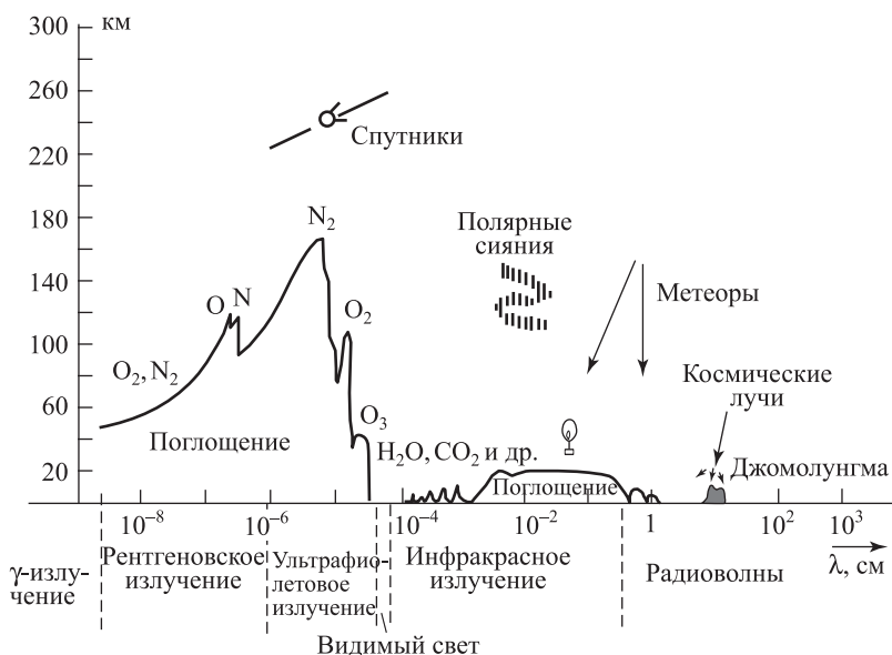
Рис. 5.1. Прохождение электромагнитных волн через атмосферу Земли. Толстой линией на рисунке указана высота, до которой проникает космическое излучение данной длины волны. В тех местах, где линии нет, излучение проникает до поверхности Земли
