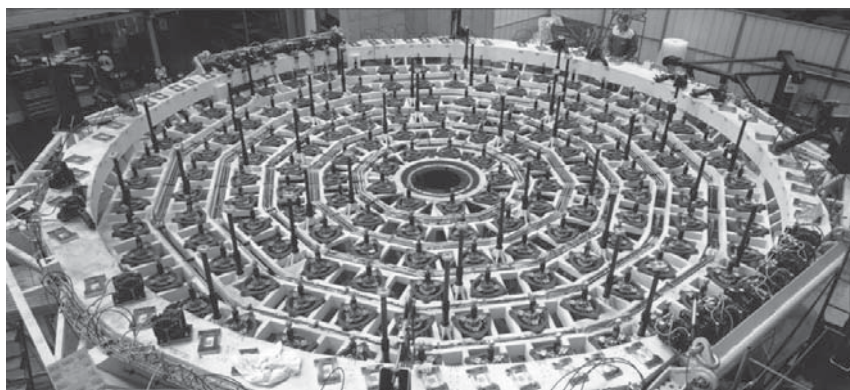
Рис. 6.3. Оправа 8,2-м главного зеркала одного из телескопов VLT Европейской южной обсерватории. Видна система разгрузки и управления формой зеркала при помощи актюаторов. Для контроля за формой зеркала используется датчик волнового фронта с разрешением 30 \times 30
