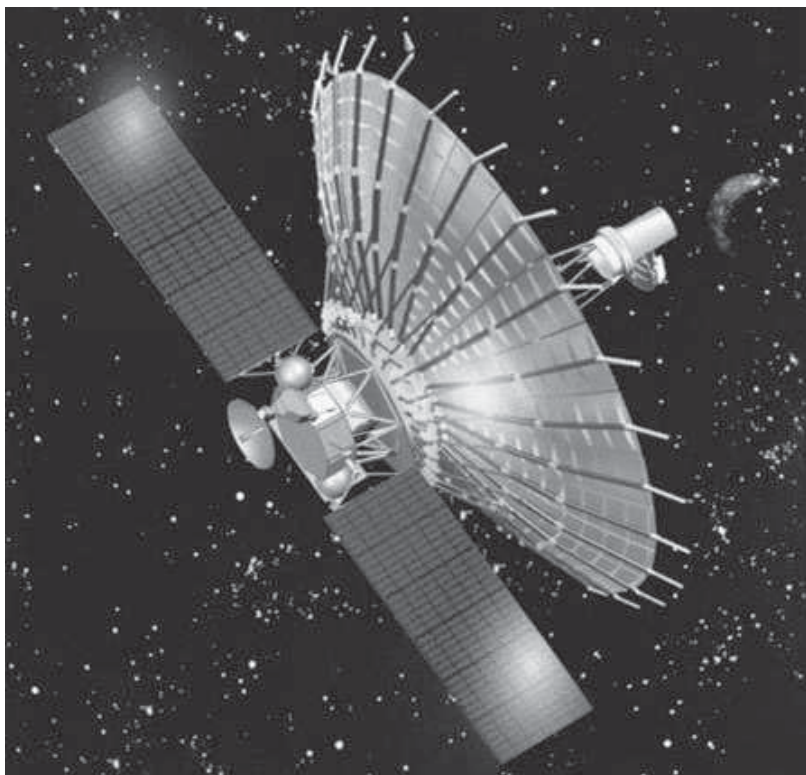
Рис. 5.15. Проект отечественного космического радиотелескопа «Радиоастрон» с раскладным зеркалом диаметром 10 м. Совместно с наземными радиотелескопами в режиме радиоинтерферометра при удалении от Земли на 300 000 км он должен иметь угловое разрешение до одной миллионной доли угловой секунды
