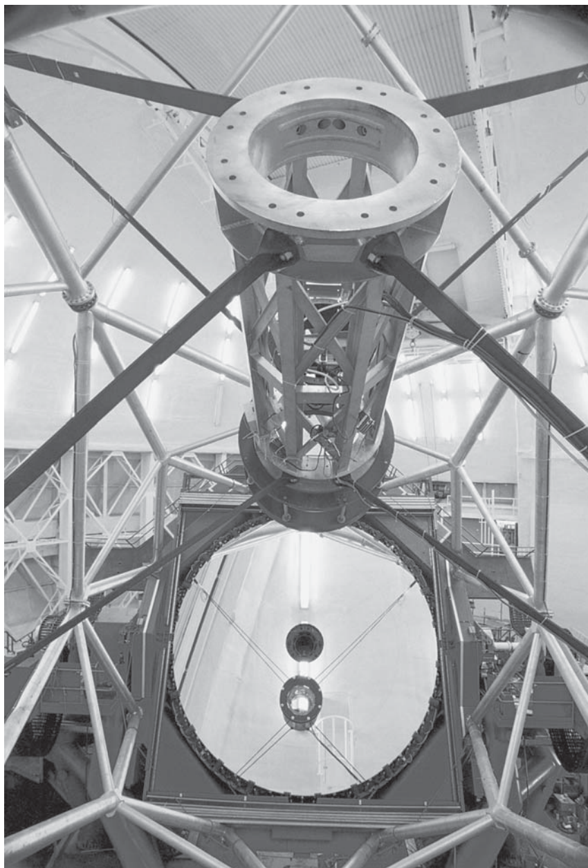
Рис. 3.46. 8,1-м телескоп Gemini North на горе Мауна Кеа (о. Гавайи), построенный в 2000 г. Его сравнение с 5-м телескопом «Хейл» демонстрирует существенное облегчение конструкции крупных рефлекторов
