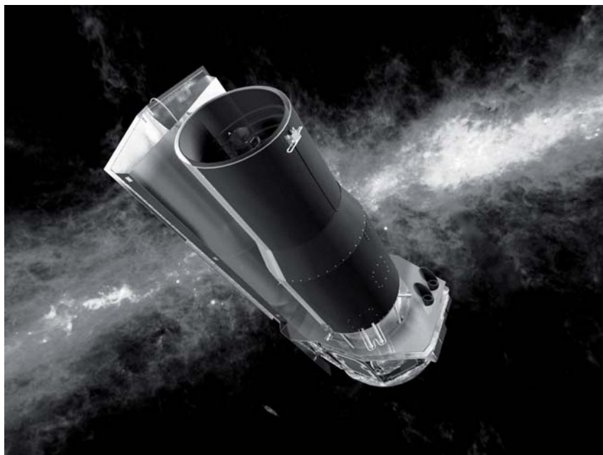
Рис. 5.11. Космическая инфракрасная обсерватория «Спитцер», ведущая наблюдения в диапазоне 3–180 мкм. В период подготовки ее называли SIRTf (The Space Infrared Telescope Facility), а после запуска дали имя известного астрофизика Лаймана Спитцера (1914–1997). Аппарат движется по гелиоцентрической (практически земной) орбите, удаляясь от Земли со скоростью около 0,1 а. е./год. Его телескоп с бериллиевым зеркалом диаметром 85 см и приборы (камера, спектрометры и фотометры) охлаждаются жидким гелием. (Рисунок: NASA/JPL-Caltech)
