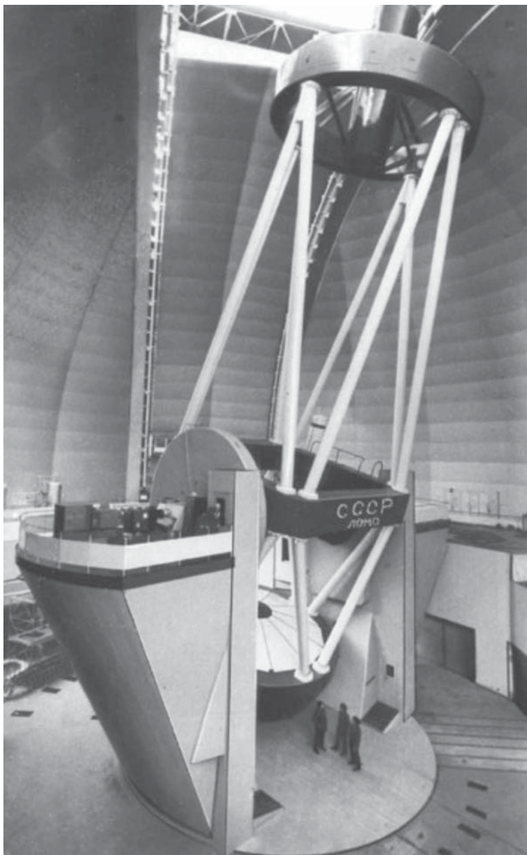
Рис. 6.4. Телескоп БТА Российской академии наук с главным зеркалом диаметром 6 м был первым крупным телескопом, установленным на альт-азимутальной монтировке
