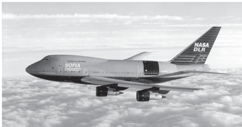
Рис. 5.2. Летающая обсерватория SOFIA (Stratospheric Observatory for Infrared Astronomy) на базе самолета Boeing 747 SP. Ее 2,5-м телескоп расположен в хвостовом отсеке и предназначен для наблюдений в ИК-диапазоне (Фото: NASA/USRA)
