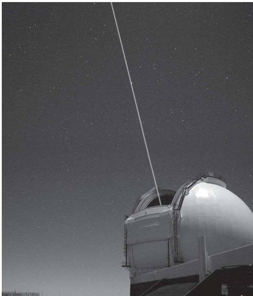
Рис. 3.39. Лазерный луч, выходящий из башни телескопа «Кек», возбуждает искусственную звезду в стратосфере. Если «звезда» формируется на высоте 10–15 км, то ее свечение обусловлено рэлеевским рассеянием; при формировании источника на высоте 90–95 км его свечение связано с резонансным рассеянием света на атомах натрия
