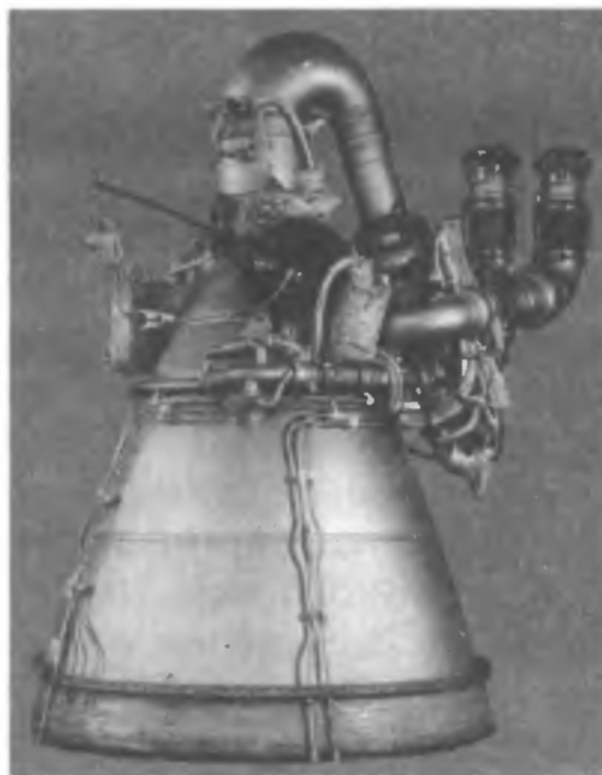
Рис. 4.8. Жидкостный ракетный двигатель РД-0210 второй ступени РН 8К82 К
