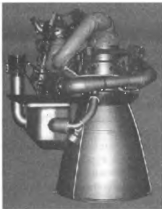
Рис. 4.7. Жидкостный ракетный двигатель РД-253 первой ступени РН 8К82К
