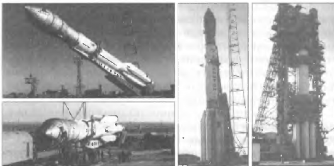
Рис. 4.12. Этапы установки РН 8К82К на пусковое устройство
