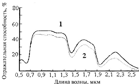
Рис. 1.6. Отражательная способность листьев сои (1) и кукурузы (2) с одинаковым содержанием влаги (66–80%)
