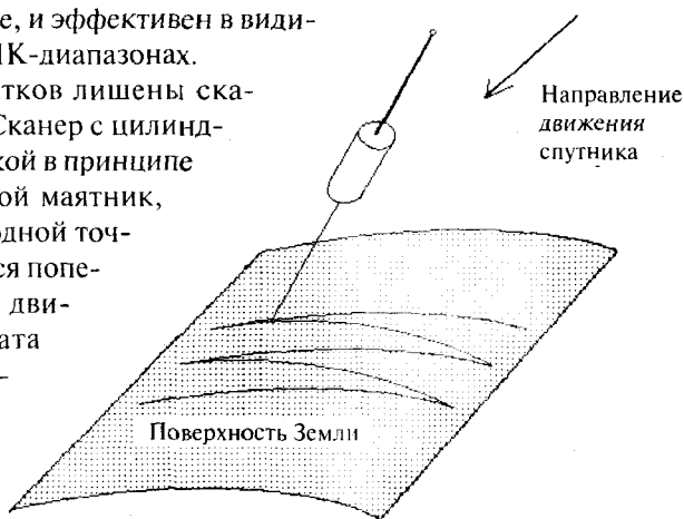
Рис. 1.9. Схема сканирования поверхности Земли
