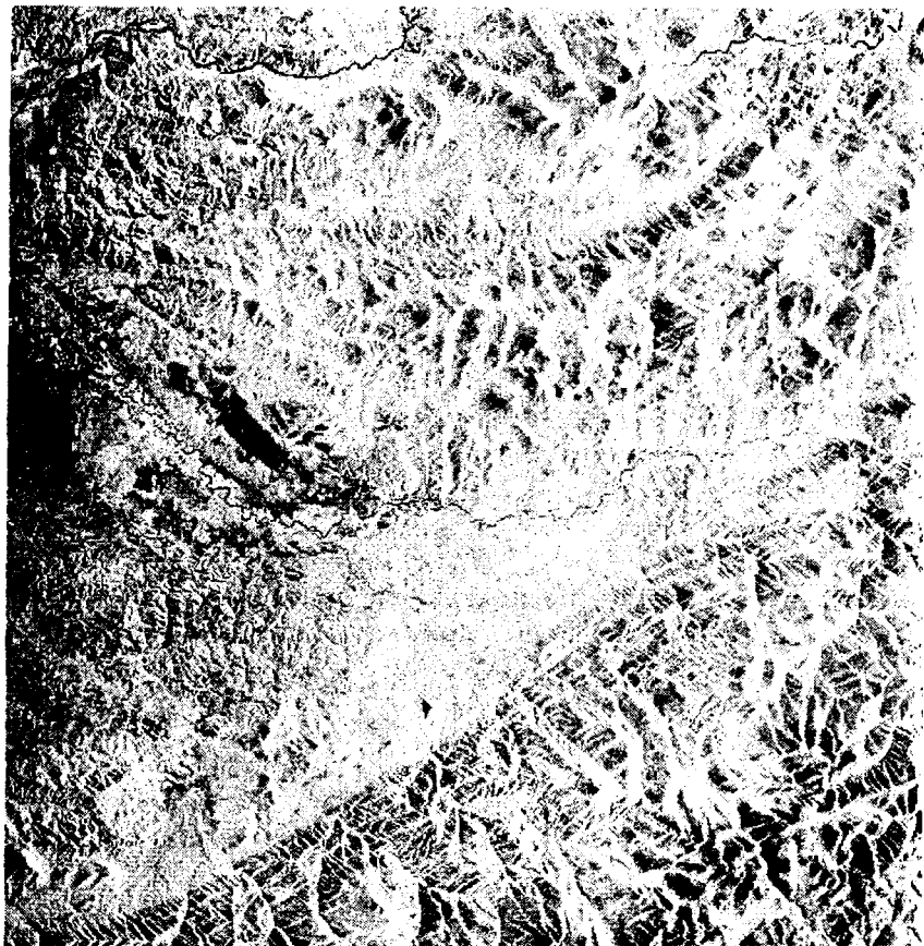
Рис. 1.16. Радиолокационное изображение горной местности на юге Красноярского края (разрешение 100 м, вертикальная поляризация)
