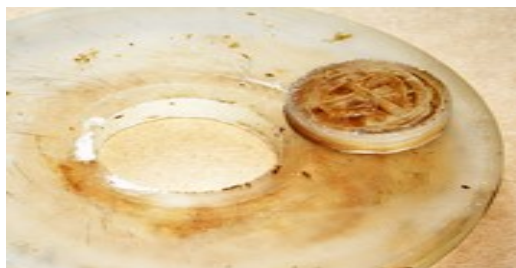
Рис. 1.23. Заготовка для предфокальной линзы высверлена, отверстие в апертурной линзе подготовлено.
