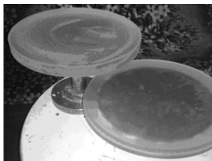
Рис. 3.6. Фронтальная линза и ее шлифовальник.
