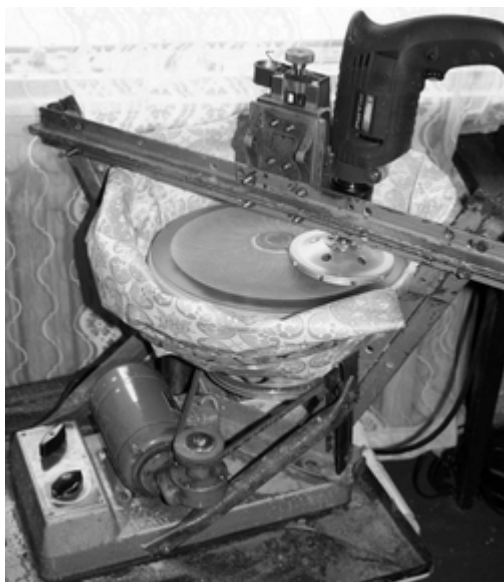
Рис. 3.2. Обдирка фронтальной линзы.
