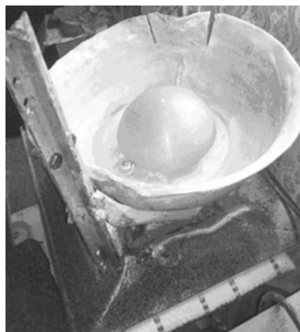
Рис. 3.5. Гриб для фасетировки отверстия
