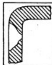
Рис. 2. Отверстие в стенке обоймы насоса
