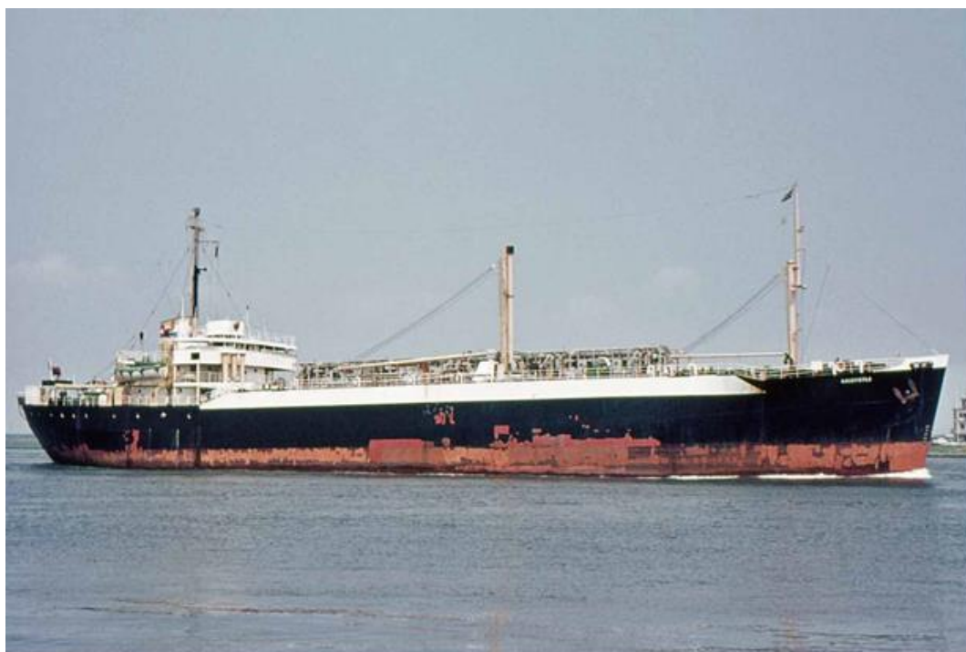
Рисунок 1 Первое в мире судно для перевозки СПГ «Methane Pioneer» («Aristotle») переоборудованное из сухогруза «Marlin Hitch»
