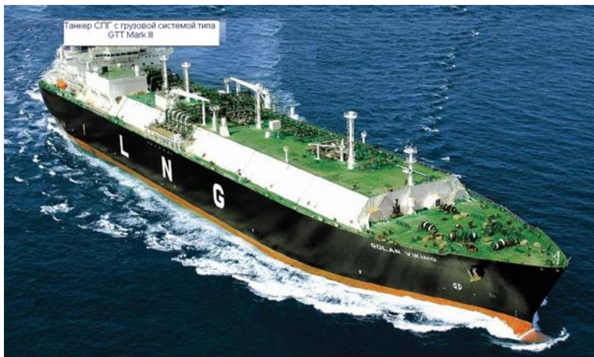
Рисунок 11 Танкер СПГ грузопместимостью 140 200 м 3 . с грузовыми танками системы GTT Mark III
