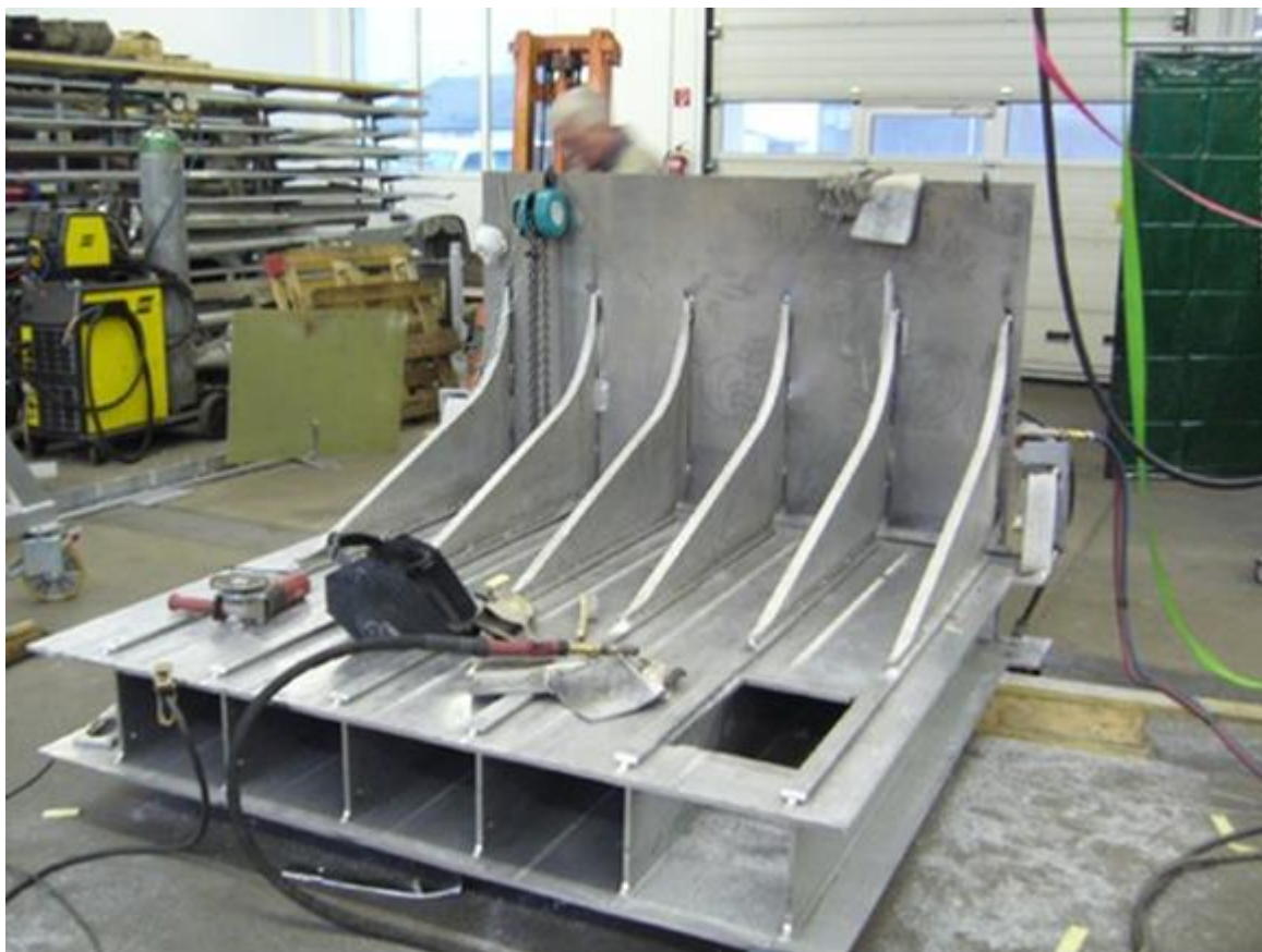
Рисунок 33 Строительство опытного образца системы хранения ADBT
