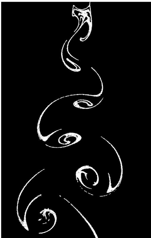
Рис. 25. Вихревая дорожка в жидкости (Бакай, Сигов, 1996)
