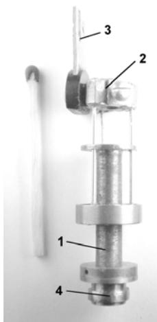
*Рис.42. Микроманипулятор для введения в мозг многоканальных стеклянных микропипеток 1- втулка с микрометрической нарезкой (шаг – 100 мкм); 2- микровинт для фиксации микропипетки; 3- отметчик глубины погружения хемотрода в ткань мозга; 4- шаровая опора для изменения угла (трека) проходки хемотрода.*
