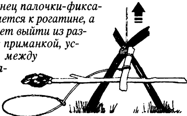
**Натяжной пружинный силок.** Используется для ловли мелких животных. Устанавливается на тропе.
