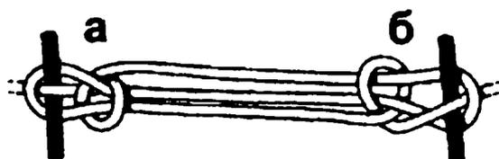
Кольшку можно сделать более надежной, пропустив палку в изгиб веревки и позади ее пассивной части (а). Или, если вы достаете до конца веревки, пропустите палку через шлаг (б).
