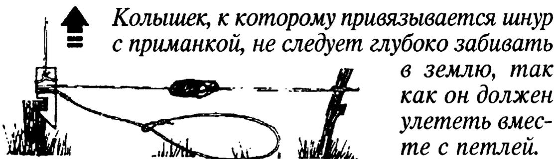
**Пружинный силок-стойка с приманкой.** Забейте в землю разветвления деревянной рогатины (либо концы двух связанных вместе палок). Шнур от согнутого дерева привязывается к небольшой палочке и к силку. Затем палочка, которая будет фиксировать
