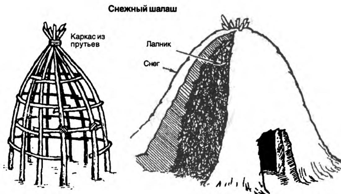
**Снежный шалаш.** Во многих пособиях по выживанию рекомендуют строить иглу — дом из снежных блоков. Однако в действительности построить такой дом, не имея соответствующего опыта, инструментов и материала (очень плотного снега), крайне сложно.
