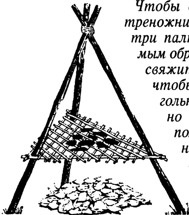
*Чтобы сделать коптильню-треножник, воткните в землю три палки, которые тем самым образуют треугольник, и свяжите вверху их концы, чтобы образовалась треугольная пирамида. Примерно на половине высоты получившегося треножника сделайте платформу в виде решетки и разведите под ней огонь.*
