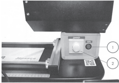
Рис. 2.5. Осветительный модуль: 1 – кнопка включения/выключения; 2 – диммер для регулировки мощности излучения
