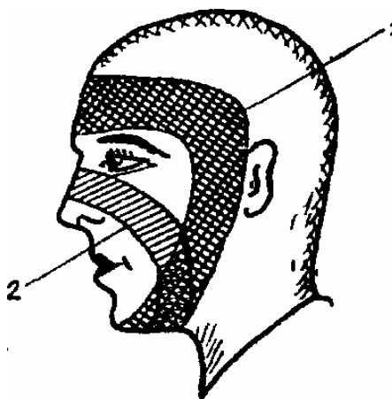
Рис. 1.5. Полосы обтюрации современных средств защиты органов дыхания: 1- для лицевых частей противогазов; 2 - для респираторов.
