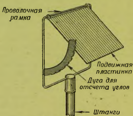
Рис. 86. Ветромер системы Аркадьева
