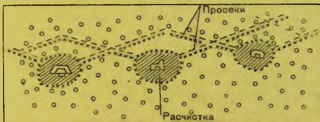
Рис. 137. Демаскирующие признаки блокгаузов
