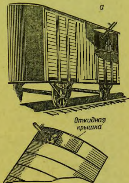
Рис. 165. «Боевое окно» для зенитного пулемета в вагоне:
