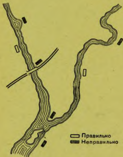
Рис. 178. Правильное и неправильное расположение зданий у реки
