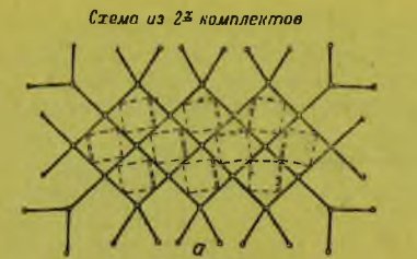
Схема сплетения веревкой каркаса маски при установке, веревка показана пунктиром
