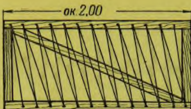
Рис. 118. Рама для подвижного перекрытия рва
