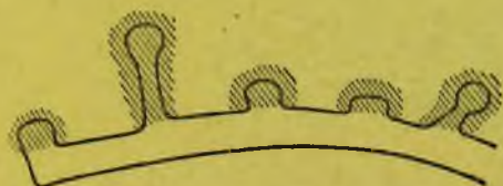
Рис. 134. Схема маскировки окопа под траншею. Заштрихованные ячейки замаскированы
