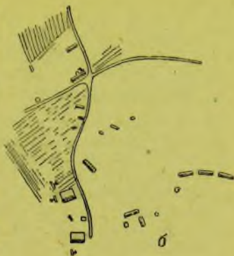
Рис. 200. Сборные ангары на полевом аэродроме: а — аэрофотоснимок; б — схема дешифрирования
