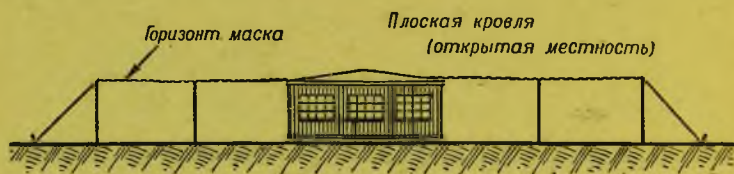
Рис. 186. Плоская крыша здания облегчает маскировку
