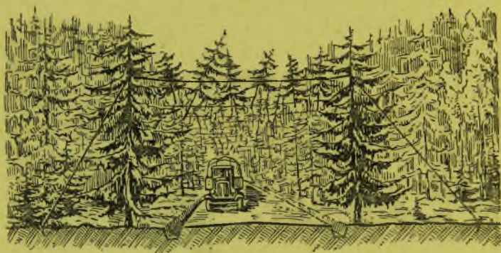
Рис. 153. Маскировка дороги подвеской крон
