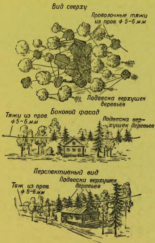
Рис. 184. Маскировка здания в лесу
