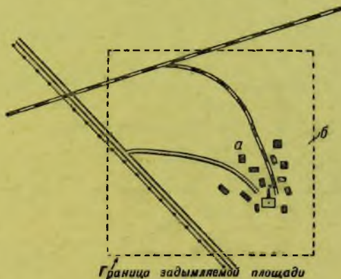
Рис. 88. Схема определения задымляемой площади: а — объект задымления; б — задымляемая площадь
