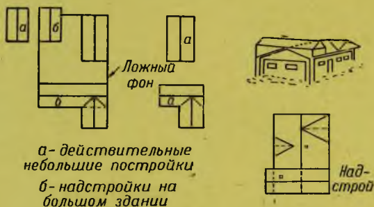
Рис. 70. Схема маскировки объекта надстройками
