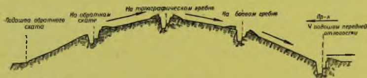
Рис. 108. Расположение фортификационных сооружений по рельефу местности
