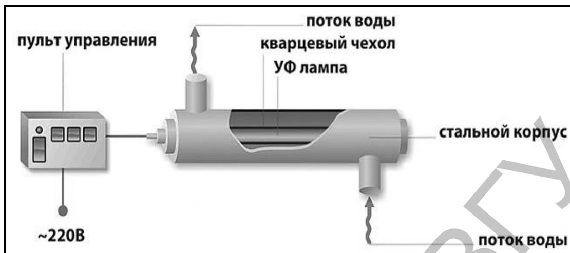
Рис. 3.8. Установка ультрафиолетового обеззараживания воды
