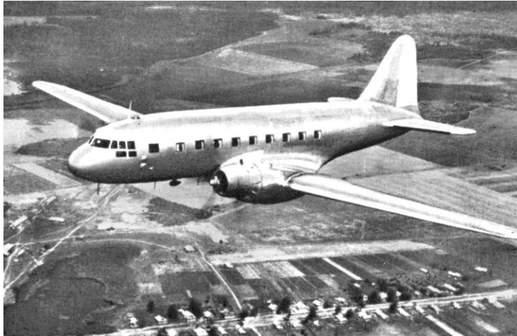
Самолёт Ил-12 с двумя двигателями АШ-82ФН
