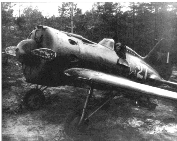
И-16 тип 24. На самолёте установлены пусковые устройства для РС
