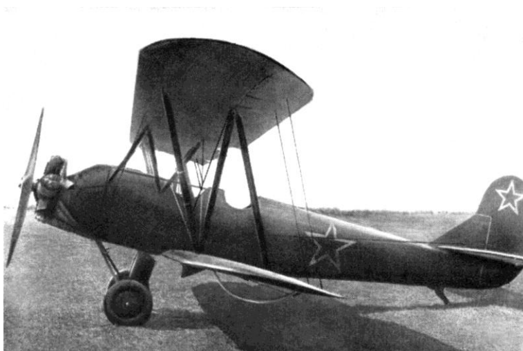
Самолёт У-2 (По-2) с двигателем М-11
