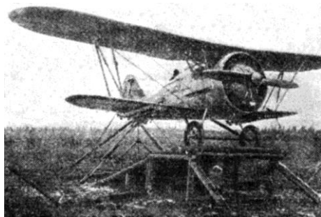
Истребитель И-5 установлен на помосте для опытной стрельбы реактивными снарядами
