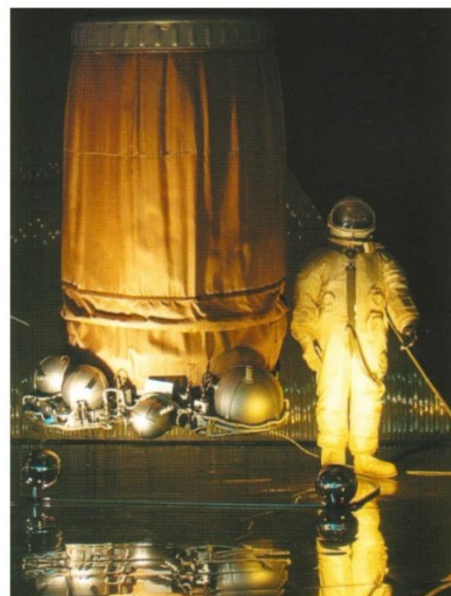
Шлюзовая камера с скафандр "Беркут" с автономной системой жизнеобеспечения для выхода в открытый космос
