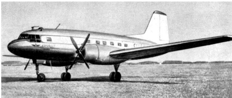
Самолёт Ил-14 с двигателем АШ-82Т
