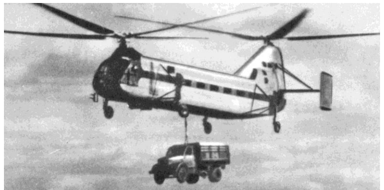
Вертолёт Як-24 с двигателем АШ-82В
