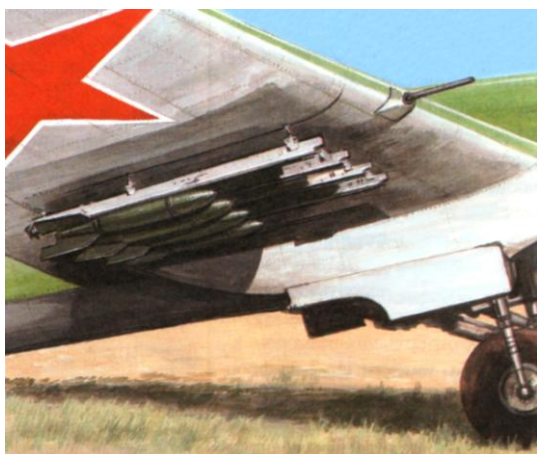
Реактивные снаряды РС-82, подвешенные под крылом Ил-2
