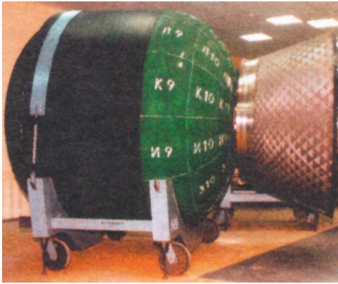
Крупногабаритный твёрдо-топливный ракетный двигатель. Разработан в НПО «Искра»
