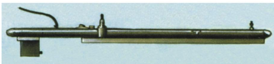
Общий вид направляющей балки, устанавливаемой под крылом боевого самолёта
