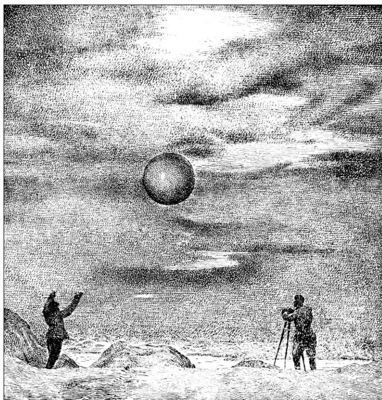
Выпуск шара-пилота. Наблюдая в стоящий на треноге прибор за движением шара, получают сведения о скорости и направлении ветра на разных высотах
