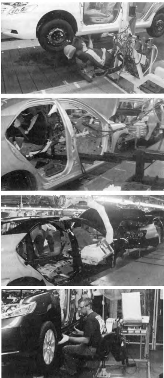
Рис. 9.3. Примеры приспособлений для сидения, позволяющих избежать неудобного положения
