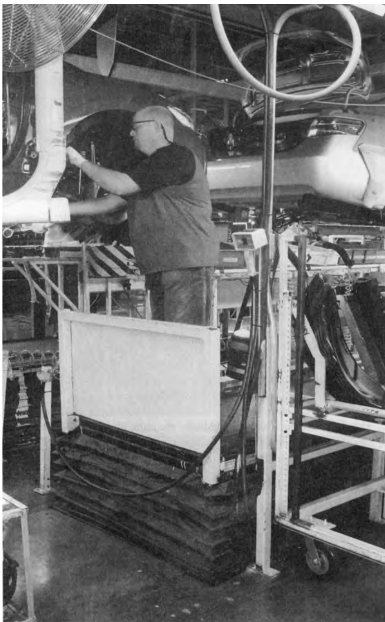
Рис. 9.4. Пример регулируемой платформы для людей разного роста
