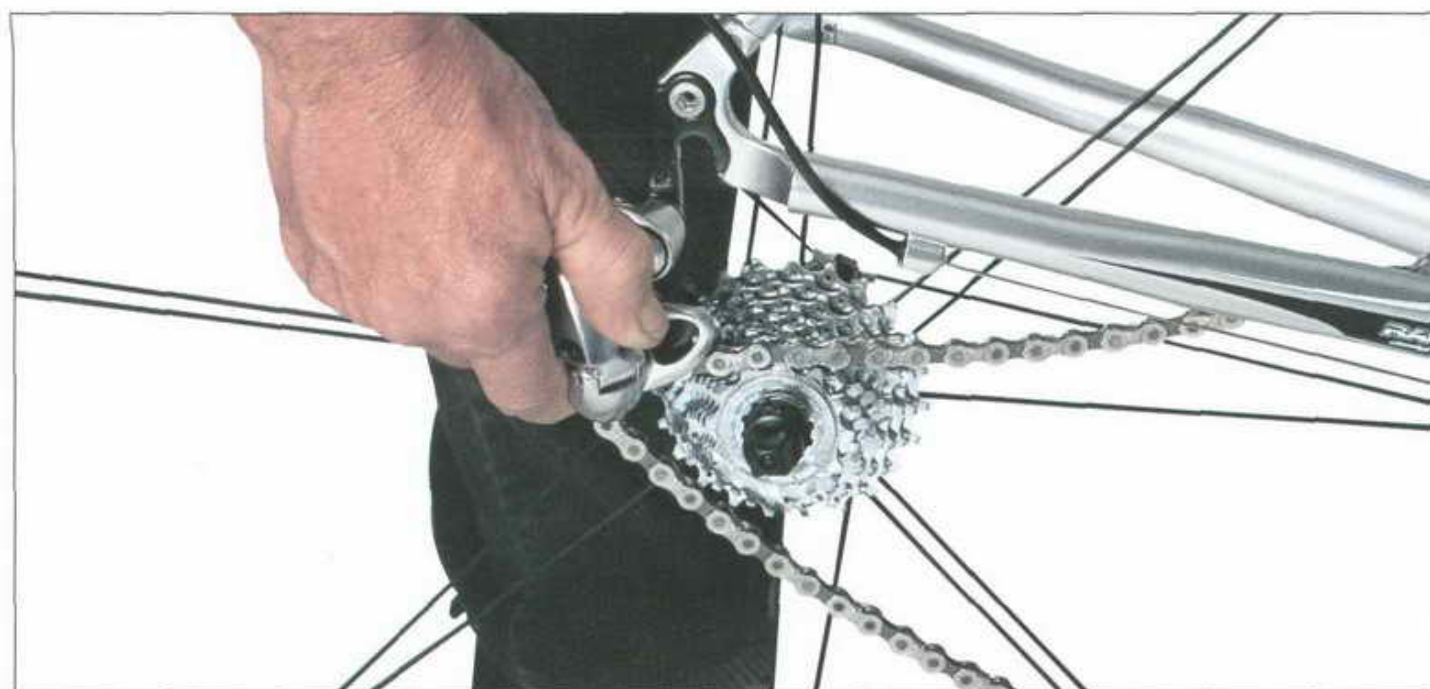
Вверху. Снятие заднего колеса Справа. Установка заднего колеса
