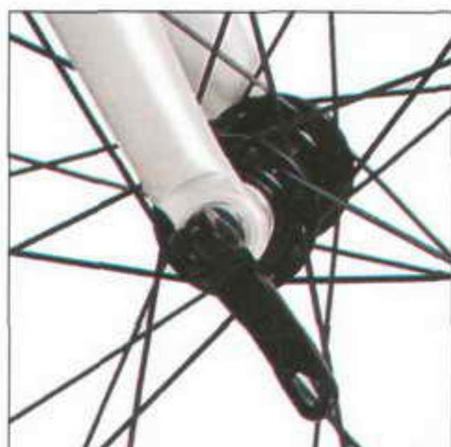
Вверху. Передняя и задняя втулки Справа. Быстросъемное эксцентриковое крепление в закрытом (вверху) и открытом (внизу) положениях
