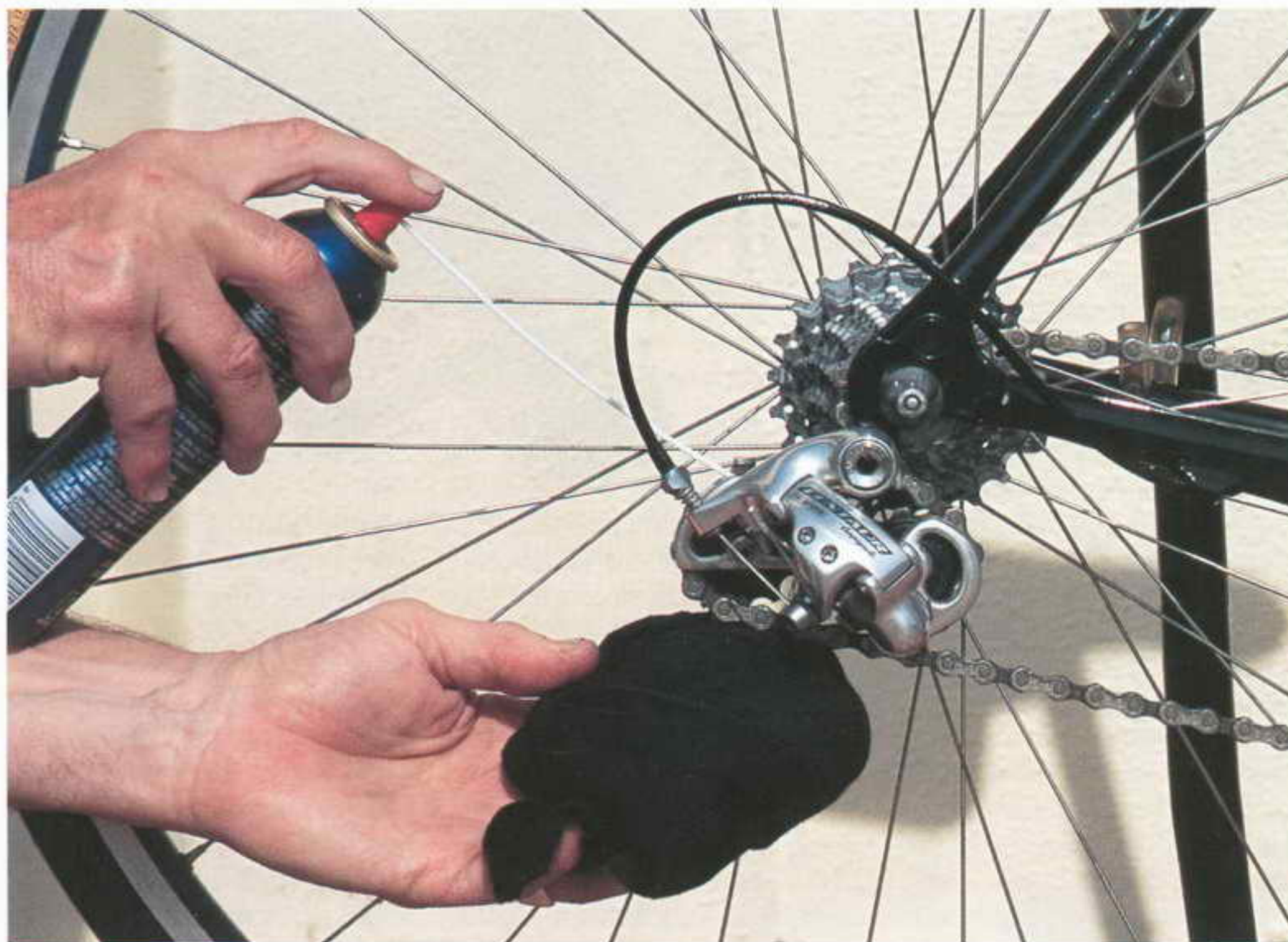
Слева. Чистка и смазка цепи и звездочек уменьшит их износ Внизу. Комплект звездочек
