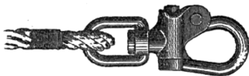
Рис. 6.45. Вертлюжная скоба для такелажа спинакера
