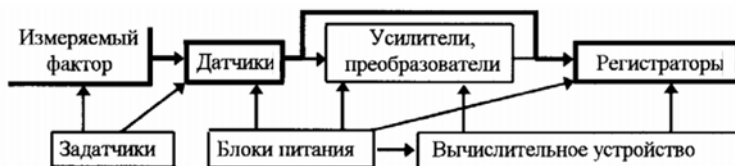
Рис. 4.3. Блок-схема измерительной установки. Тонкими линиями очерчены блоки, которых может в установке и не быть.
