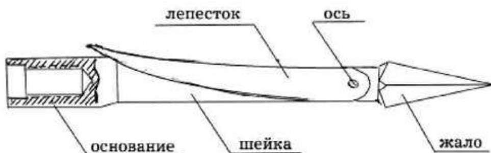
Рис. 1 Схема одинарного наконечника
