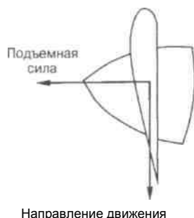
Рис. 4.6 Направление действия подъемной силы, создаваемой пропеллером
