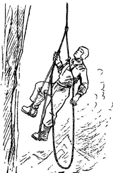
Рис. 49. Подъем при помощи схватывающих узлов
