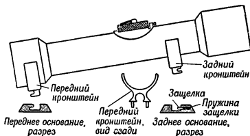
Рис. 141. Детали для укрепления на ружье (карабине, винтовке) оптического прицела
