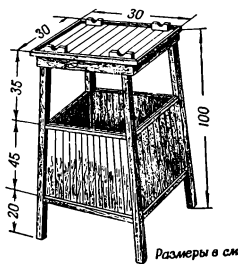
Рис. 328. Переносной столик для стрелка на траншейном стенде и его размеры
