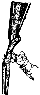
Рис. 384. Определение усилия спуска курка весом ружья. Если усилие, требуемое для спуска курка, равно весу ружья или больше, то из такого ружья невозможна успешная стрельба на охоте (ружье будет нязить)
