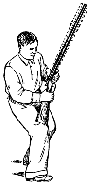
Рис. 54. Определения наличия качки стволов на осевом болте
