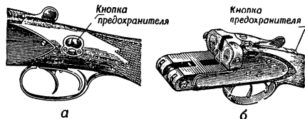
Рис. 46. Различное расположение кнопки предохранителя: а — кнопка сбоку; б — кнопка сверху
