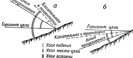
Рис. 298. Зависимость угла встречи от угла места цели: а — при стрельбе сверху вниз; б — при стрельбе снизу вверх
