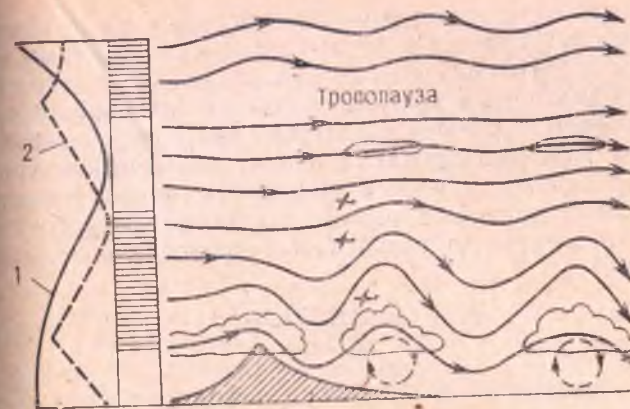
Рис. 7.2. Схема волн препятствий в зависимости от распределения скорости ветра и температуры воздуха с высотой:
