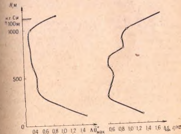
Рис. 4.12. Осредненный профиль перепада температуры и влажности воздуха в термиках по сравнению с окружающим воздухом в подоблачном слое
