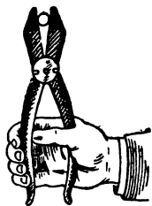
Рис. 71. Так работают плоскогубцами и клещами
