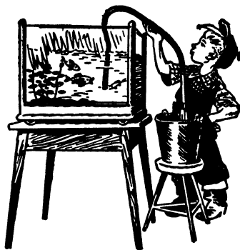
Рис. 37. Переливание жидкости сифоном
