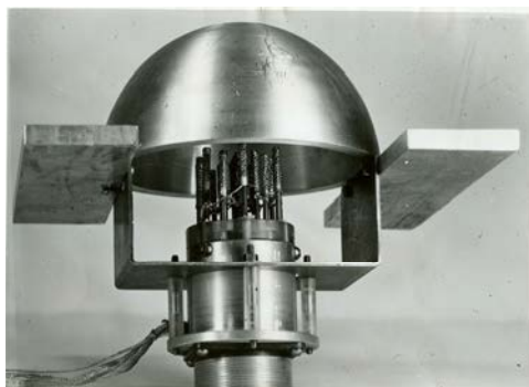
Сборка для проведения рентгеновского опыта с контактными датчиками
