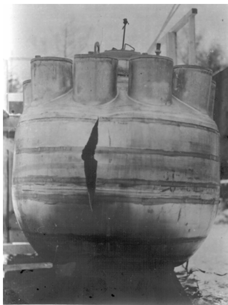
Модель 1:10 корпуса реактора БН-800 после серии взрывных нагружений. 15 декабря 1983 год
