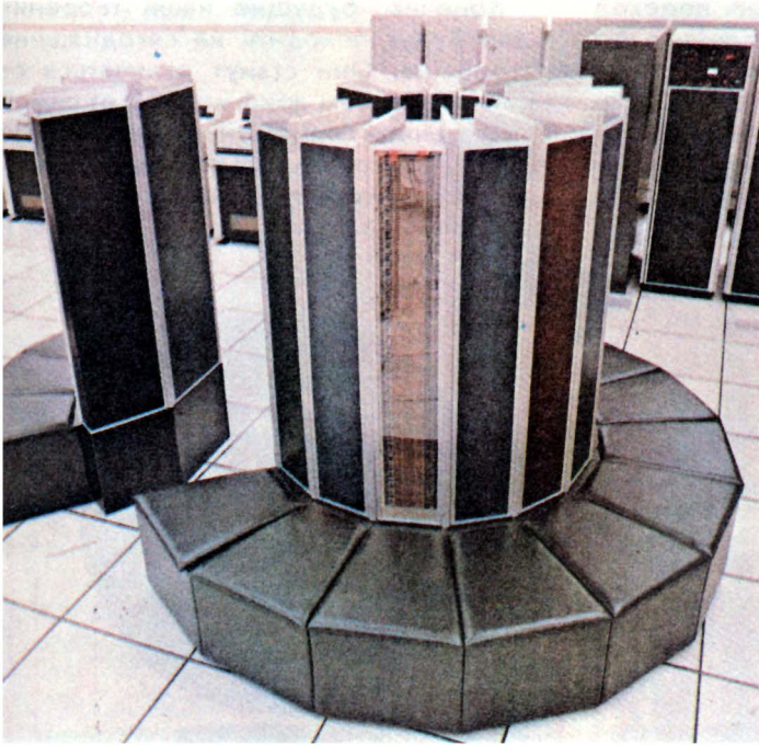
А это воплощение современных представлений о помощнике-компьютере: суперкомпьютер Цибер-205 (слева), сигналы на котором передаются с одной точки на другую со скоростью, близкой к предельной во Вселенной,— со скоростью света. Центральная память и процессор суперкомпьютера другой системы — Грей-1 (справа).
