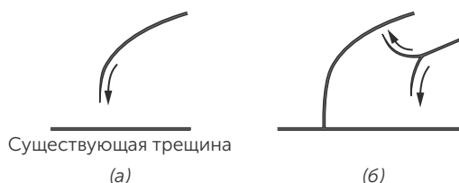
Рис. 4.9 / Задача 4.68. а) Развивающаяся трещина пересекается под прямым углом с уже существующей трещиной. б) Развивающаяся трещина разветвляется и завершает образование многоугольника.
