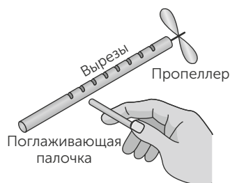
Рис. 1.53 / Задача 1.160. Пропеллер закручивается на гвоздике после того, как в палочке установятся колебания.
