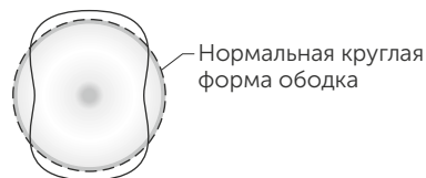
Рис. 3.4 / Задачи 3.43 и 3.44. Вид сверху на колеблющийся ободок стеклянного бокала (деформация при колебаниях сильно преувеличена).
