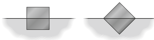
Рис. 2.15 / Задача 2.44. Две ориентации плавающего бруска с квадратным сечением.
