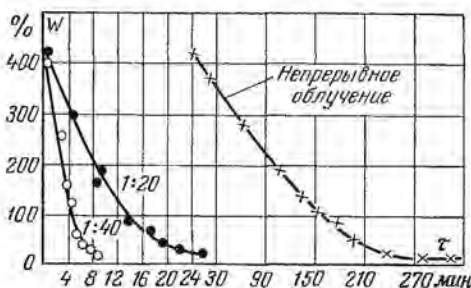
Рис. 6-9. Кривые сушки коллоидного тела (картофель) при непрерывном и прерывном облучении лампами инфракрасного излучения.
