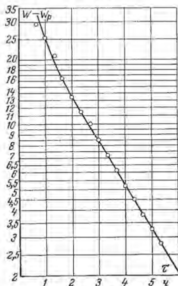
Рис. 2-22. Изменение влагосодержания тела (гипсовой пластины) в процессе сушки.
