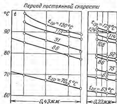
Рис. 7-8. Влияние температуры греющей поверхности на температурное поле отливок целлюлозы толщиной 0,43 и 0,22 мм.
