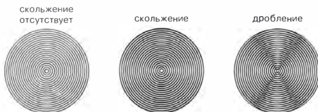
Рис. 117. Элементы контроля скольжения и дробления, построенные на концентрических окружностях
