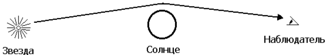
Рис. 5. Отклонение луча света вблизи поверхности Солнца.
