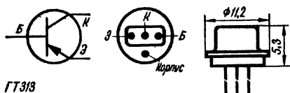
ГТ313 (А, Б). Проводимость p-n-p . Диапазон рабочих температур от -20 до +55^{\circ}\text{C} .
