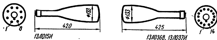
Рис. 214. Внешний вид, основные размеры и выводы электродов 13ЛО15И (по РШ5-1):
