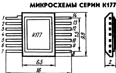
Рис. 498. Внешний вид, основные размеры и обозначение выводов микросхемы К177
