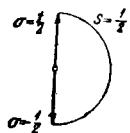
Рис. 58. Ориентация спина по отношению к заданному направлению; возможны только две ориентации — параллельно и антипараллельно к этому направлению.
