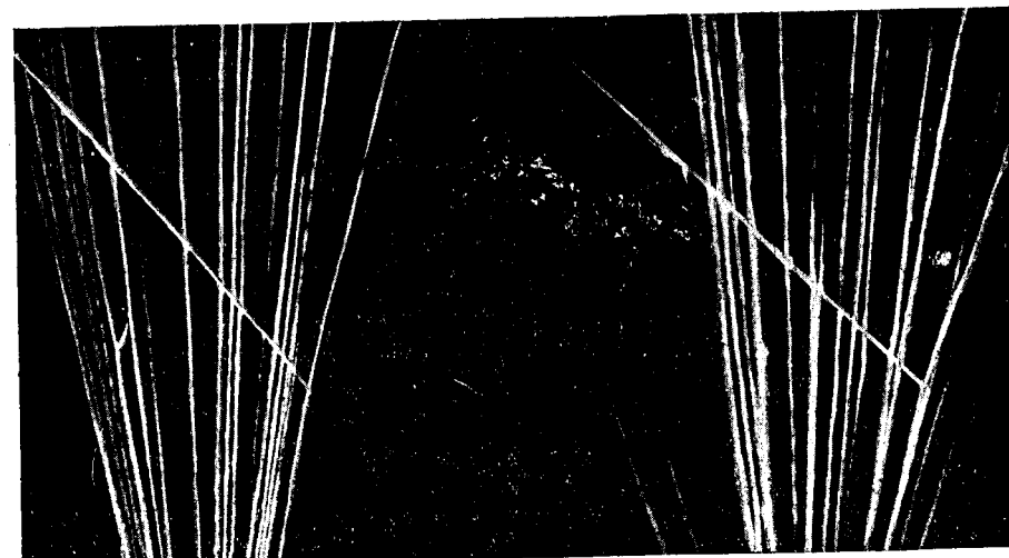
Рис. 22. Стереоскопический Вильсоновский снимок процесса расщепления атома (по Блеккету). Превращение азота с поглощением \alpha -частицы. Ясно видно разделение луча (пути \alpha -частицы); из двух ветвей более слабая соответствует протону, выбитому из ядра азота, а более сильная — ядерному остатку.
