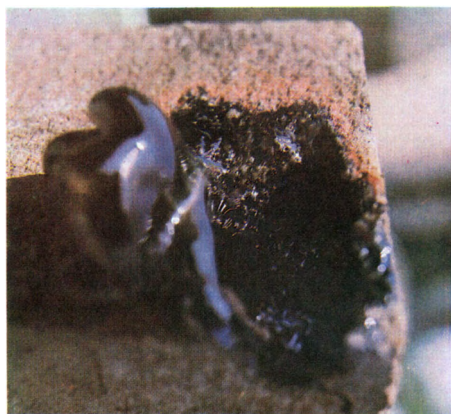
Солнечные печи, созданные учеными Института электроники и Физико- технического института АН Узбекской ССР в Ташкенте, легко плавят гранит, который был в нашем представлении символом твердости.
