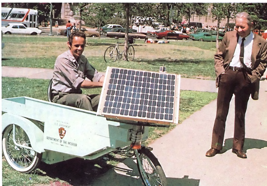
Солнечные батареи для грузовой тележки и речного бакена (внизу) сделаны в виде плоских прямоугольных панелей.
