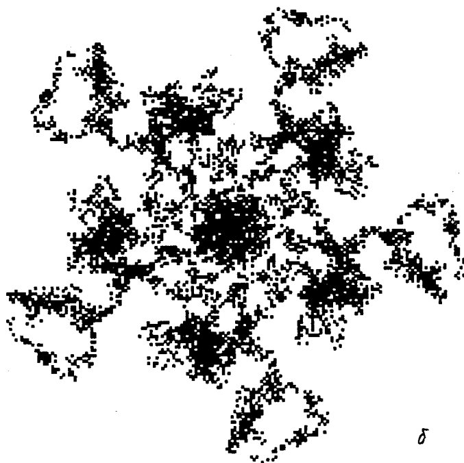
Рис. 6.19. Фрактал, образованный диффузией с симметрией 5-го порядка при K_0 = 3,5 : a – размер квадрата 800\pi \times 800\pi , число шагов 160000, б – часть, заключенная в малом квадрате на рис. a , число шагов 9826
