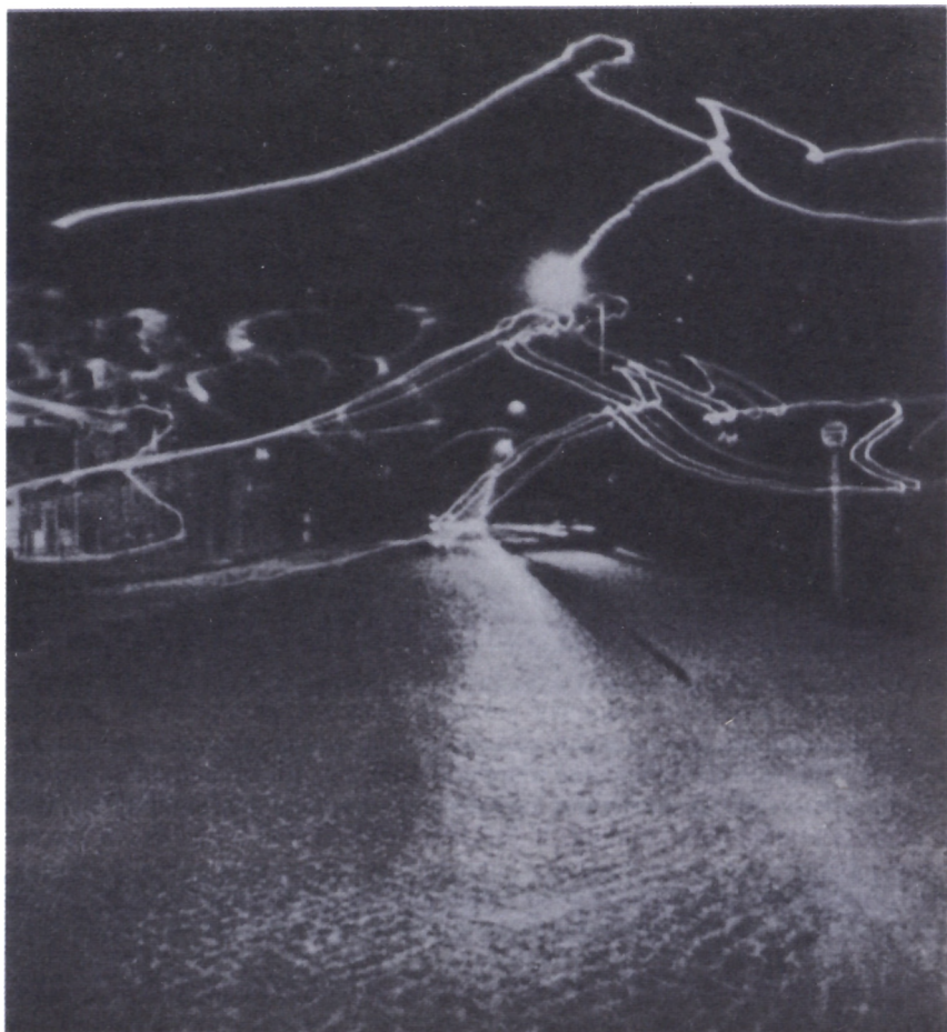
Рис. 5.11. Фотография ночной улицы. Камера специально двигалась для получения множественных следов [353]. Основной след – уличный фонарь; модуляция его интенсивности связана с изменением (частота 50 Гц) электрической мощности. Эта фотография использовалась для того, чтобы поставить под вопрос подлинность фотографии, приведенной на рис. 5.7.
