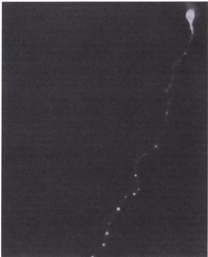
Рис. 2.14. Фотография похожего на четочную молнию канала разряда, инициированного индукционной катушкой с напряжением 2 \cdot 10^7 В и энергией около 12 Дж в импульсе. Приведенный снимок — один из пяти кадров, сделанных 16-мм кинокамерой со скоростью 30 кадров в секунду. Структура типа четочной молнии явно представляла собой остаток канала высоковольтного разряда и существовала всего около 0,16 с. Фотография сделана Р. Голкой и опубликована впервые.
