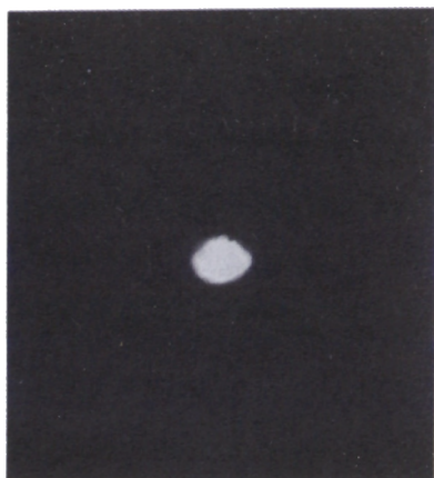
Рис. 5.37. Фотография созданного в лаборатории светящегося коронного разряда [1092]. Корона и вспышечные стримеры наблюдались вблизи положительно заряженного острия диаметром 2 мм, размещенного над плоским электродом.
