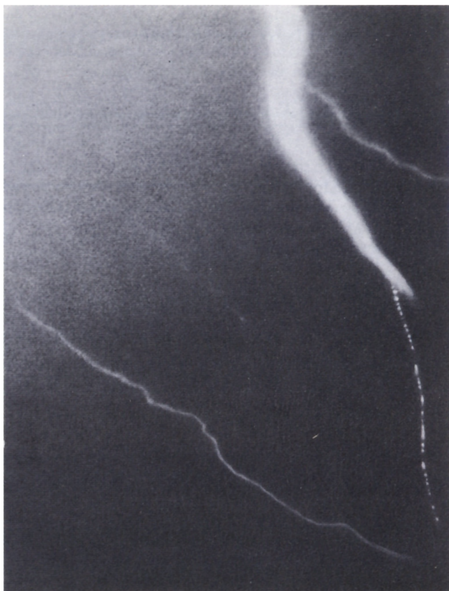
Рис. 5.16. Фотоснимок, являющийся частью фотографии ночного неба, сделанной метеоритной службой Смитсоновской астрофизической обсерватории [1787]. Затвор автоматически работающей камеры открывал объектив на 25 мс, закрывал его на 38 мс, проводя открытие или закрытие за 6 мс. Движущийся светящийся объект был бы зарегистрирован в виде серии пунктирных линий. Анализ изображения и параметры камеры приводят к выводу, что на снимке зарегистрирован одиночный светящийся объект, падающий со скоростью 60–120 м/с и имеющий диаметр 2–4 м. Широкая вертикальная полоса в верхнем правом углу была идентифицирована как канал обычной молнии, закончившийся над землей. Непрерывный пунктирный след от конца этого канала к земле идентифицирован как след шаровой молнии. Похожая фотография приводилась в работе [1789] и позже в работах [505, 506].
