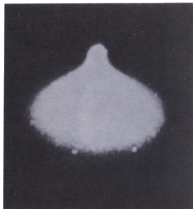
Рис. 5.37. Фотография созданного в лаборатории светящегося коронного разряда [1092]. Корона и вспышечные стримеры наблюдались вблизи положительно заряженного острия диаметром 2 мм, размещенного над плоским электродом.
