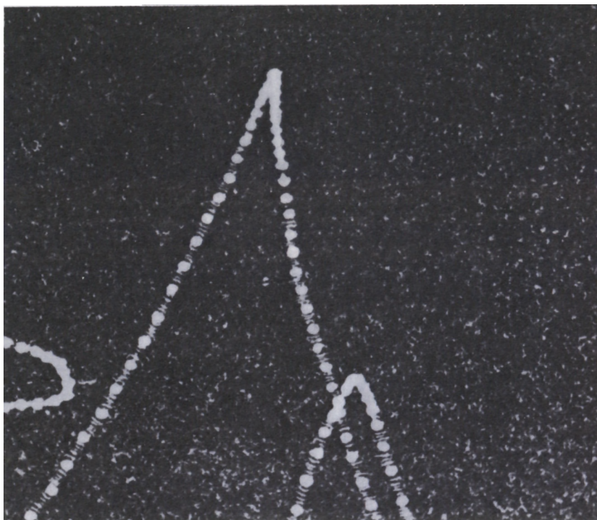
Рис. 2.3. Фотография уличного фонаря, сделанная намеренно перемещаемой камерой с целью получения следа с переменной яркостью [366]. Этот снимок ставит под сомнение интерпретацию рис. 2.1 и 2.2 в качестве фотографий четочной молнии.
