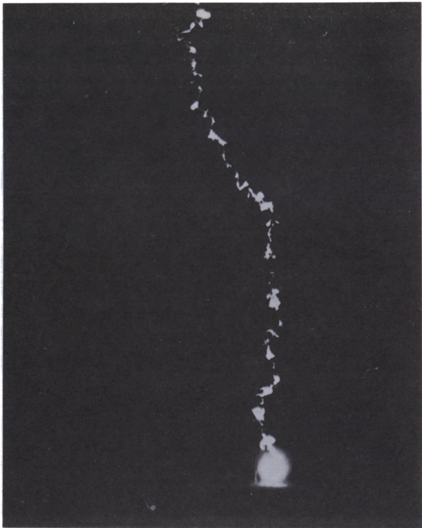
Рис. 7.3. Полученная с помощью кинокамеры последовательность фотографий продолжительного свечения, возникающего при возбуждении грозового разряда, который замыкается на заземленном объекте. Предполагается, что источником свечения могут быть подземные газы, нагретые в результате протекания тока. Воспроизводится из работы [886] с разрешения Губерта и Центра ядерных исследований Франции.
