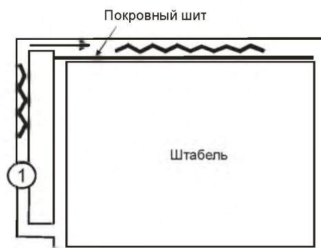
Рис. 7. Камера с внешним расположением вентилятора.
