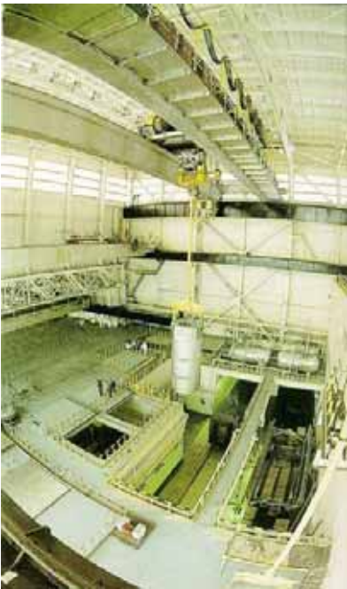
Рис.6. Выгрузка из железнодорожного вагона контейнера с отработавшим ядерным топливом на радиохимическом заводе (ГХК)
