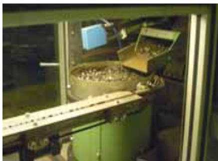
Рис. 2. Снаряжение твэла топливными таблетками на ОАО МСЗ
