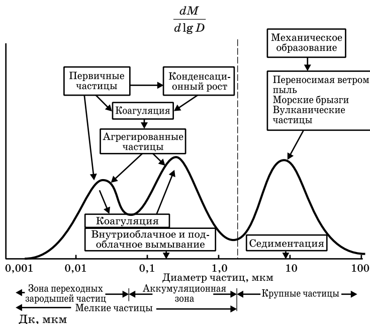
Рис. 7.1. Схема распределения атмосферных аэрозолей по размерам частиц (производная массы M от логарифма диаметра частиц)
