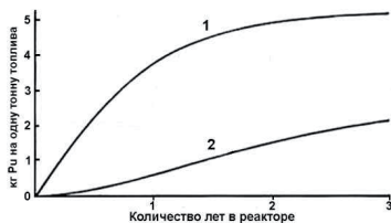
Рис. 3. Накопление изотопов плутония в реакторе (изменение изотопного состава: от оружейного – к реакторному, т.е. к негодному для оружейного использования).
