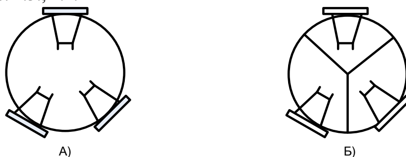
Рис. 2.3. Схемы токопроводов круглого сечения
