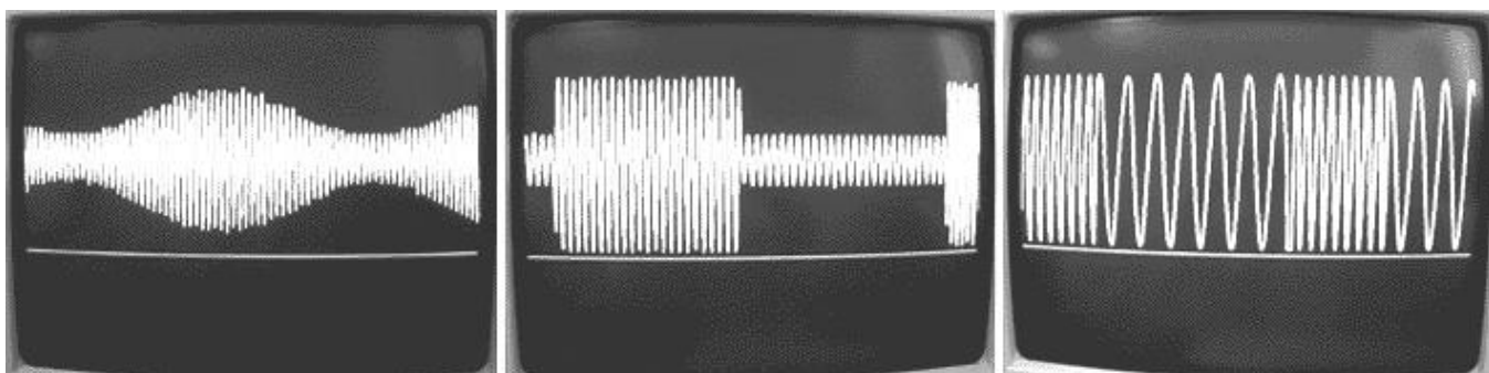
Рис. 2. Амплитудная и частотная модуляция: 1) АМ передача аналогового сигнала; 2) АМ передача цифрового сигнала; 3) ЧМ передача цифрового сигнала.
