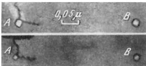
Рис. 29. Последовательные стадии залечивания поры, расположенной на дислокации (А) и в бездефектной части кристалла (В)
