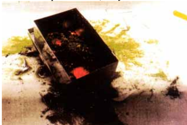
Рис. 7. Самовозгорание плутония на воздухе со свечением, подобным красным уголькам, тлеющим в золе.
