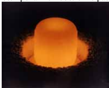
Рис. 7. Свечение блока ^{238}\text{PuO}_2 (Самонагрев).
