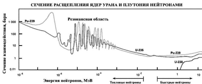
Рис. 30. Сечение деления ядер урана и плутония нейтронами.
