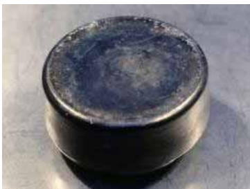
Рис. 51. Отливка из плутониево-галлиевого сплава (плутониевый пит).
