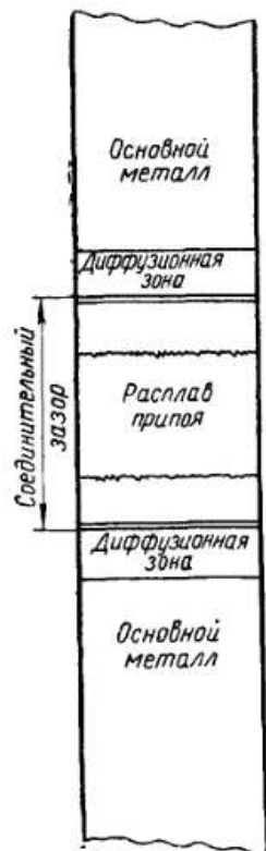
Рис. 1. Схема строения шва в начальный момент образования зоны сплавления
